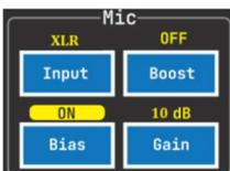
Entrée équilibrée pour connecter un microphone à condensateur, jack - XLR. Attention dans ce mode, la tension est de + 48V sur la prise d'entrée XLR.
